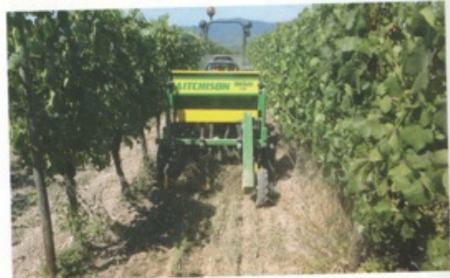
Le semis direct fonctionne également très bien dans les vignes en été : pas de pertes d'eau, pas de levées d'adventices. Sur la photo, le semoir viticole Aitchison fonctionne exactement comme son grand frère et assure un positionnement et des levées optimales en été ; la société Simtech cherche aujourd'hui à adapter ce système en vignes étroites. La société Gerber a également mis au point un semoir viticole de SD avec plusieurs dents et trémies en option.
